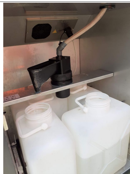
Bidons de prélèvement : nettoyer le tuyau entre le bol de prélèvement et le canal de distribution
